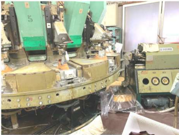
綾部の事業所で靴を製造。ポリウレタンを注入して靴底をつくる機械は日本に数台しかないそうです
