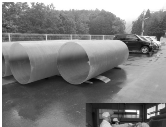
強化プラスチック製造加工の事業所。上はできあがった製品で、下水管に使用されるそうです。
